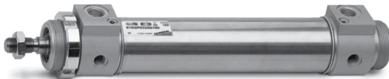
Die Konzeption dieser Zylinder ist auf maximale Kompaktheit, Anwendung in aggressiver Umgebung (Chemie, etc.) sowie für Einsatz in Bereichen mit hohem Sauberkeitsanspruch ausgelegt. Wenige Schmutzecken, d.h. leichtes Reinigen, die Verwendung von Aluminium eloxiert für Zylinderköpfe und -deckel sowie Edelstahl im Bereich von Kolbenstange und Zylinderrohr ermöglichen dies. Standardausführung ist die Magnetversion eines im Kolben integrierten Permanentmagneten zur berührungslosen Abtastung.
