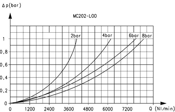
Durchflussdiagramm Modell MC202-L00
